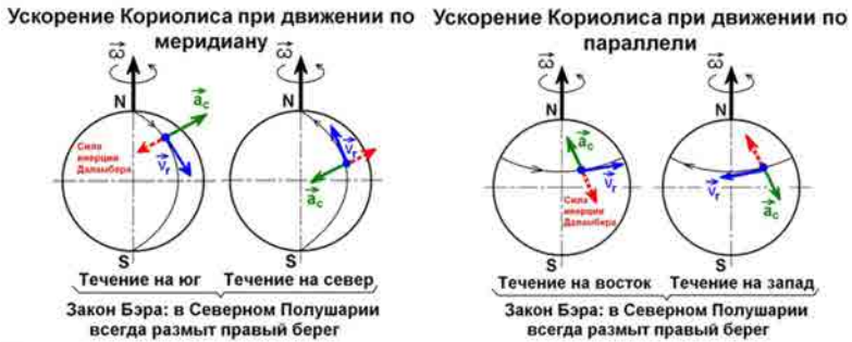
Рис.1. Направление ускорения Кориолиса и силы Даламбера в Северном Полушарии
