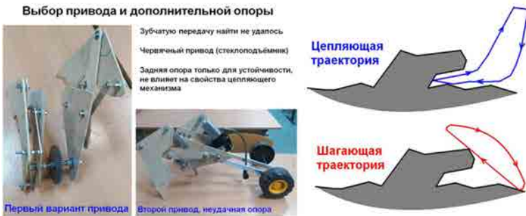
Рис. 5. Цепляющая машина и её отличие от шагающего механизма
