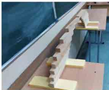
Рис.4. Конструкция новой арки
