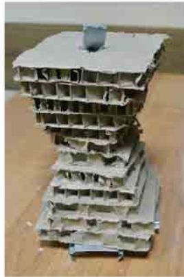
Рис.3. Первая пробная конструкция напряжённой башни из картона
