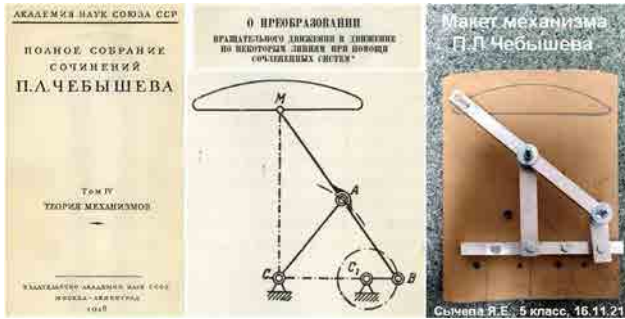
Рис. 1. Шагающий механизм П.Л.Чебышева [2]
