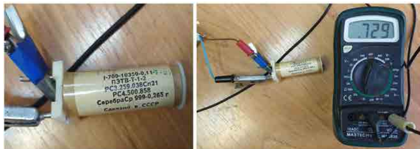
Рис.1. Катушка индуктивности для первого опыта
