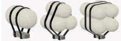
Рис. 1. Варианты конструкций дирижабля, рассматриваемые на этапе проектирования
