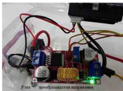
Рис.2. Фото электродвигателя (узла преобразования напряжения)
