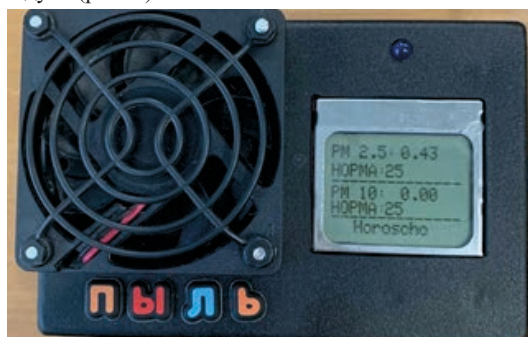
Рис. 1. Внешний вид макета для оценки запыленности воздуха
