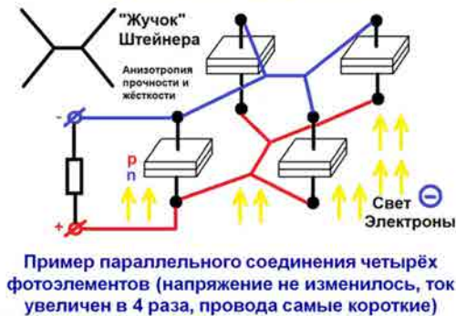
Рис. 1. Самое короткое параллельное соединение четырёх фотоэлементов
