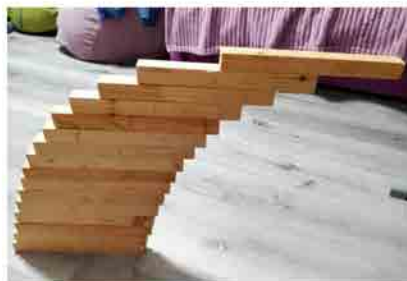
Рис.2. Схема укладки блоков без дополнительного крепления
