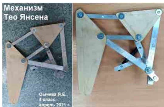
Рис. 3. Действующая модель механизма Тео Янсена
