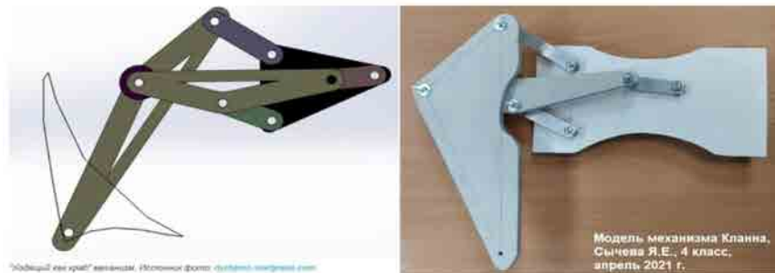
Рис. 4. Схема механизма Кланна и авторская модель
